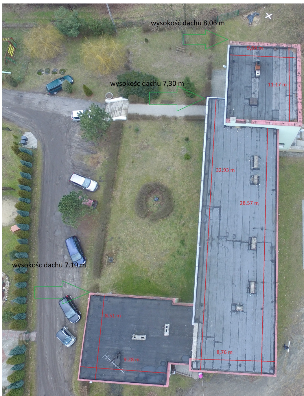
Zdjęcie 1. Stan obecny pokrycia dachowego- wymiary dachu
